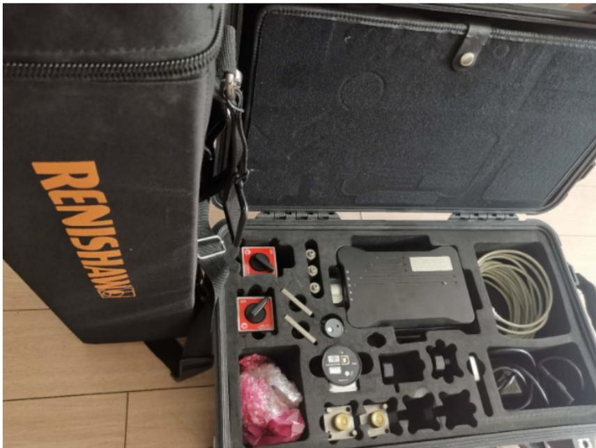
激光干涉仪：误差影响精确度：大气折射率。激光频率稳定性：在激光干涉仪中，将激光波长作为长度基准，激光频率变化直接影响测量结果。余弦误差：在测定三坐标测量机的定位误差时，需仔细调整，使光束与滑座的运动方向平等。死程误差：在零位时，激光干涉仪两相干光的还有一段光程差，这一段光程差称为死程。死程的变化会引起测量误差，死程误差是激光干涉仪的一项重要误差。细分误差：在干涉条纹一个周期内由插细分不均匀引起的误差。长沙数控机床激光干涉仪维护激光干涉仪应避免在温度变化大、有风、潮湿环境下测量。
