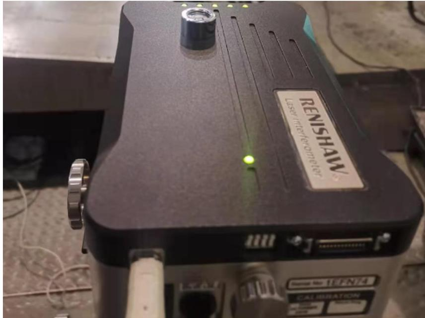
激光干涉仪的应用：1、几何精度检测可用于检测直线度、垂直度、俯仰与偏摆、平面度、平行度等。2、器的误差，而且还能通过RS232接口自动对其线性误差进行补偿，比通常的补偿方法节省了大量时间，并且避免了手工计算和手动数控键入而引起的操作者误差，同时可最大限度地选用被测轴上的补偿点数，使机床达到最佳精度，另外操作者无需具有机床参数及补偿方法的知识。3、数控转台分度精度的检测及其自动补偿现在，利用ML10激光干涉仪加上RX10转台基准还能进行回转轴的自动测量。它可对任意角度位置，以任意角度间隔进行全自动测量，其精度达 $\pm 1$ 。比传统用自准直仪和多面体的方法不只节约了大量的测量时间，而且还得到完整的花转轴精度曲线，知晓其精度的每一细节，并给出按相关标准处理的统计结果。激光干涉仪的测量精度高：以激光干涉技术为关键。四川机床精度激光干涉仪哪个牌子好
