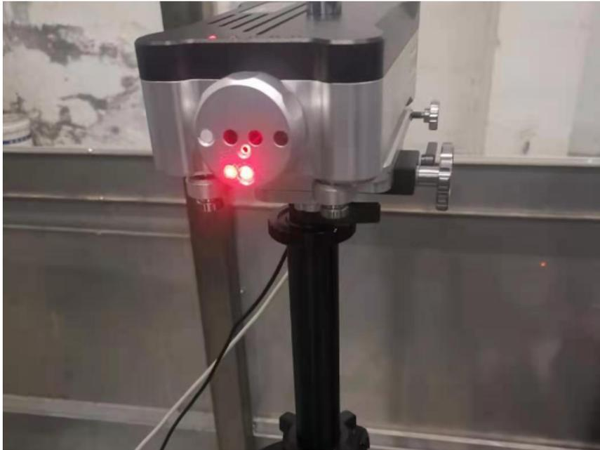
激光干涉仪；光的干涉：光具有波粒二象性。两列或几列光波在空间相遇时相互迭加，在某些区域始终加强，在另一些区域则始终削弱，形成稳定的强弱分布的现象。产生稳定干涉的条件：只有两列光波的频率相同，位相差恒定，振动方向一致的相干光源，才能产生光的稳定干涉。由两个普通独特光源发出的光，不可能具有相同的频率，更不可能存在固定的相差，因此，不能产生稳定干涉现象。若光的振幅相等：相位角相同时，复合光强为原先的2倍，产生明条纹。当相位角相差 $180^\circ$ （半个波长）时，复合光强为0，产生暗条纹。
